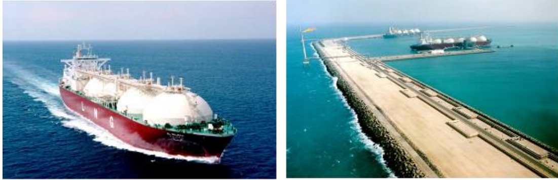
Εικόνα 3: Αριστερά(α) ειδικά κατασκευασμένο δεξαμενόπλοιο για μεταφορά υγροποιημένου Φ.Α.-LNG και δεξιά(β) σταθμοί εκφόρτωσης. 5
