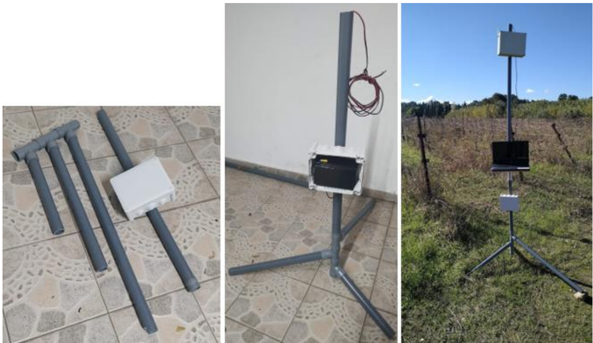
Εικόνα 11 - Κατασκευή και δοκιμή σταθμού μετρήσεων (LoRa Node)
