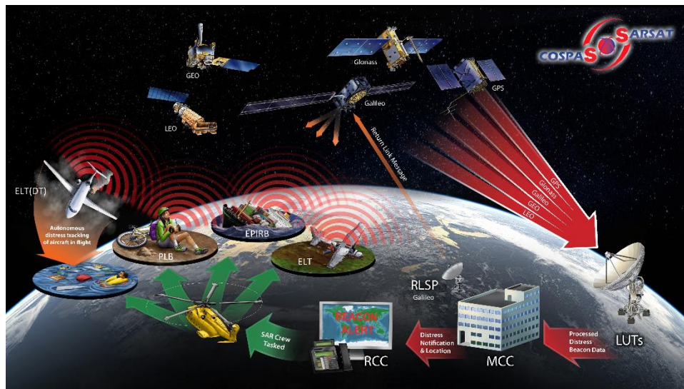
Εικόνα 4: The MEOSAR system concept (Πηγή: cospas-sarsat.int )
