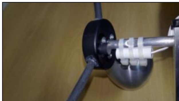
Εικόνα 35: Ιδιοκατασκευή αισθητήρα ταχύτητας ανέμου 49
