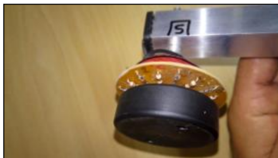
Εικόνα 38: Διάταξη αυτοσχέδιου ανεμοδείκτη 56
