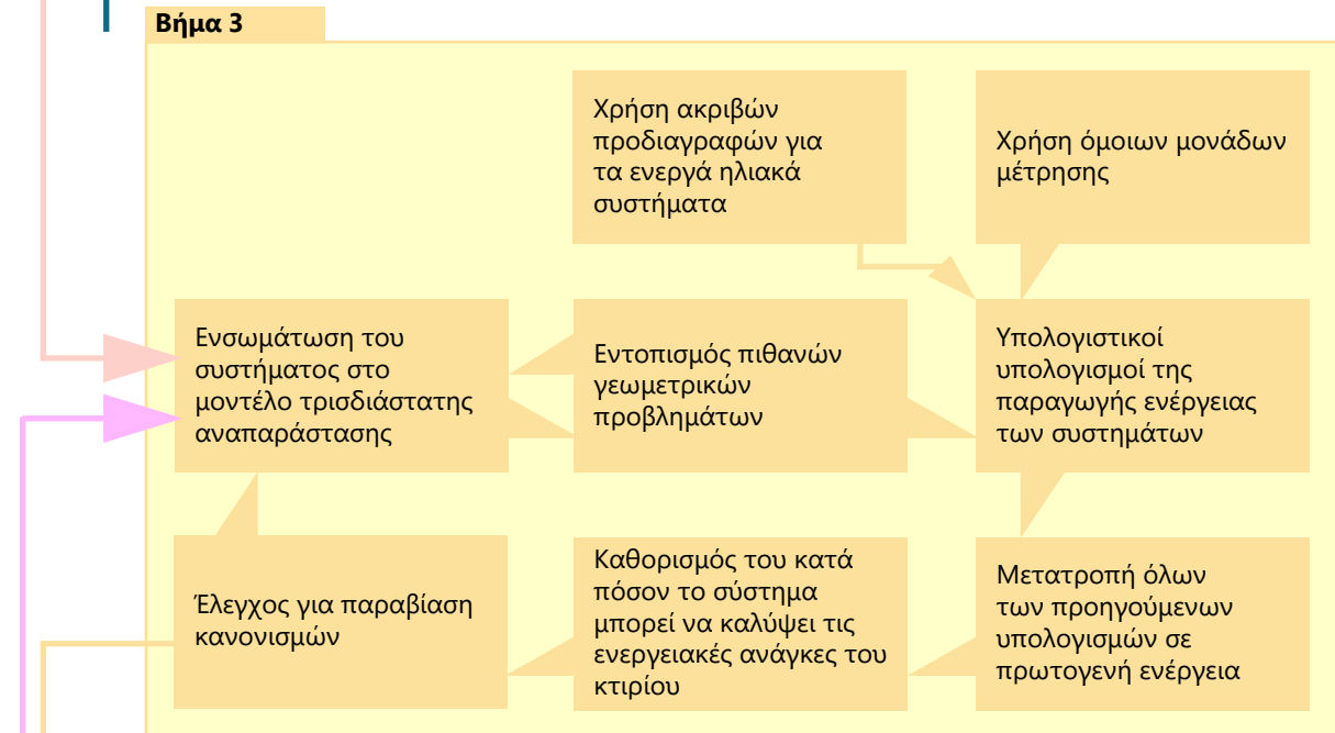
Εικόνα 21 Η βασική μεθοδολογία για το τρίτο βήμα, που ασχολείται με την ενσωμάτωση ενός επιλεγθέντος ενεργητικού ηλιακού συστήματος και την προσομοίωση της ενεργειακής παραγωγής του.
