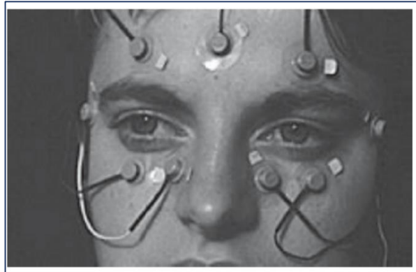
Εικόνα 4.2.1: Παράδειγμα μέτρησης των οφθαλμικών κινήσεων μέσω της Ηλεκτροοφθαλμογραφίας. (Πηγή: duchowski,2007 )
