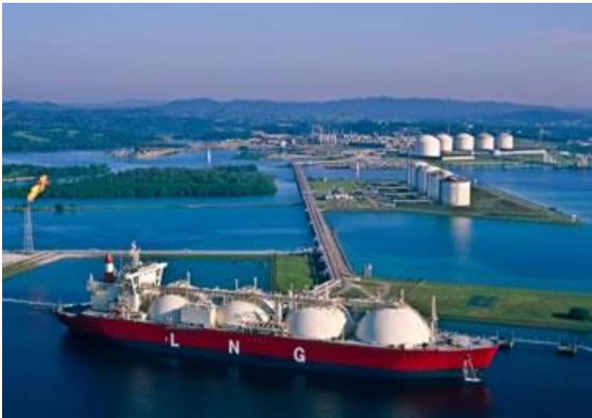
Εικόνα 4: Ειδικά κατασκευασμένο δεξαμενόπλοιο για μεταφορά υγροποιημένου Φ.Α.-LNG και στο βάθος της εικόνας οι δεξαμενές αποθήκευσης και ο θερματικός σταθμός αποϋγροποίησης. 6
