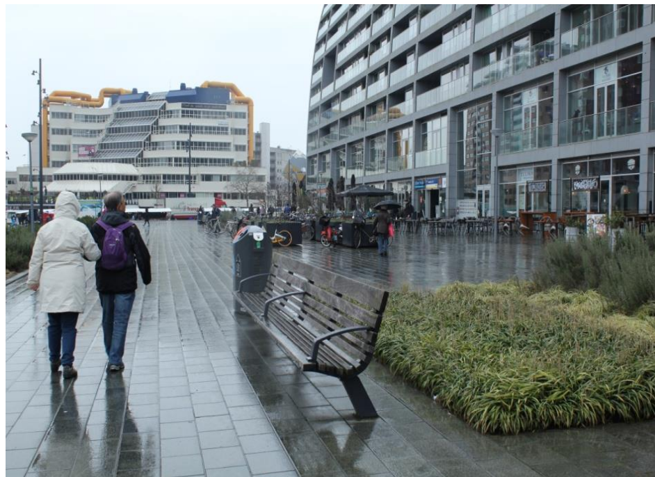
Εικ.76: Παγκάκι στο Ρότερταμ απο μεταλλικά πόδια και ξύλινο κάθισμα. Οι ενδιαμεσοι αγκώνες είναι καταλλήλοι για να βοηθούν τους γηρεότερους.
