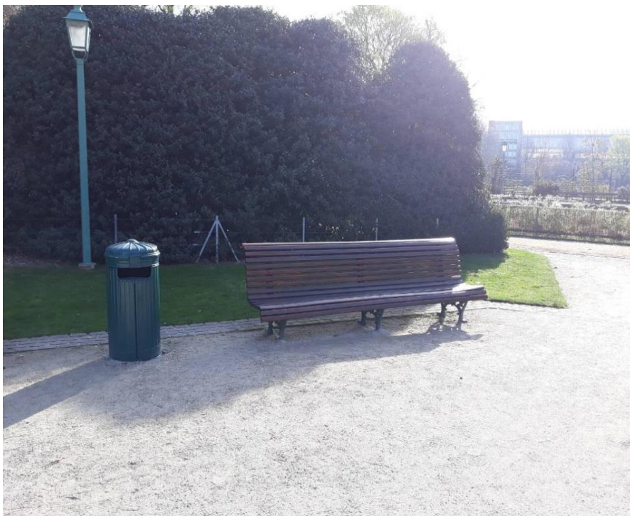
Εικ. 13: Το παγκάκι σε πάρκο στις Βρυξέλες είναι κατασκευασμένο από παράλληλες λωρίδες ξύλου τοποθετημένες έτσι ώστε να είναι απαλές οι γωνιές του αλλά και να είναι εύκολη η διαφυγή του νερού.
