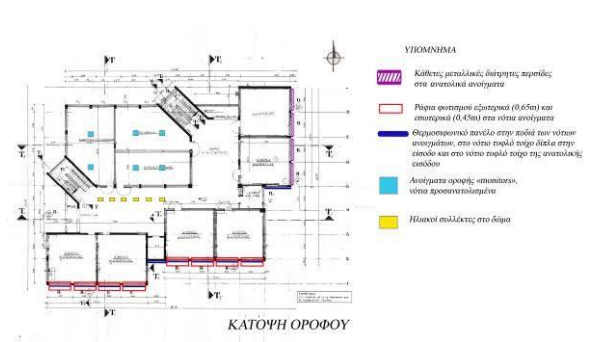
βιοκλιματικής συμπεριφοράς κάτοψη ορόφου
