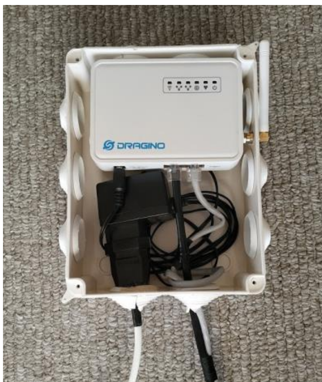
Εικόνα 10 - LoRa Gateway σε στεγανό κουτί.
