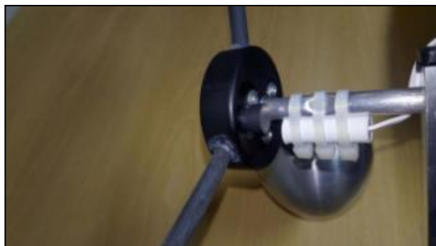
Εικόνα 35: Ιδιοκατασκευή αισθητήρα ταχύτητας ανέμου 49
