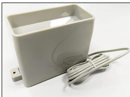
Εικόνα 44: βροχόμετρο Tipping Bucket 63
