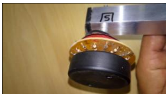
Εικόνα 38: Διάταξη αυτοσχέδιου ανεμοδείκτη 56
