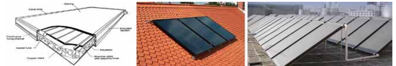
Εικόνα 4 Η δομή ενός επίπεδου ηλιακού συλλέκτη με υαλοκάλυψη και εφαρμογές αυτού σε στέγη και επίπεδη οροφή.
